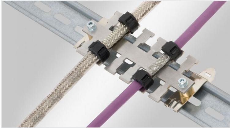
Le support de câbles KAFM convient à la décharge de perturbations liées aux perturbations électromagnétiques, qui pourraient survenir sur le blindage du câble.
